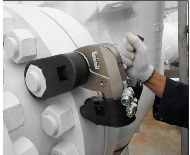
▲ Chave hidráulica de torque customizada S11000X com articulação de torque e rolete de reação.
