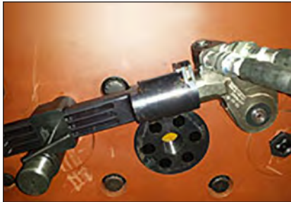
◀ Chave hidráulica de torque customizada para uma bomba de fraturamento.
